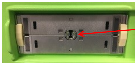
Εικόνα 9: Εγκοπή ασφαλίσης στην υποδοχή συνδέσμου του ηχοβολέα
